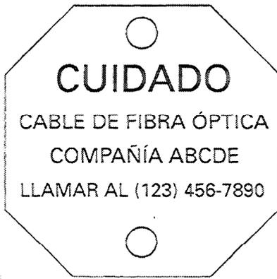
FIGURA 8.8. Etiqueta de un cable de fibra óptica.
